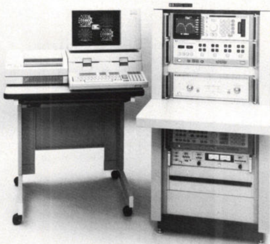
Meetstation voor volledig geautomatiseerde microgolfmetingen met computer HP9836C en printer.
