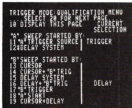
Afb. 2. Voorbeeld van een menu. Hier één van de pagina's voor de instelling van de vertraagde tijdbasis.
